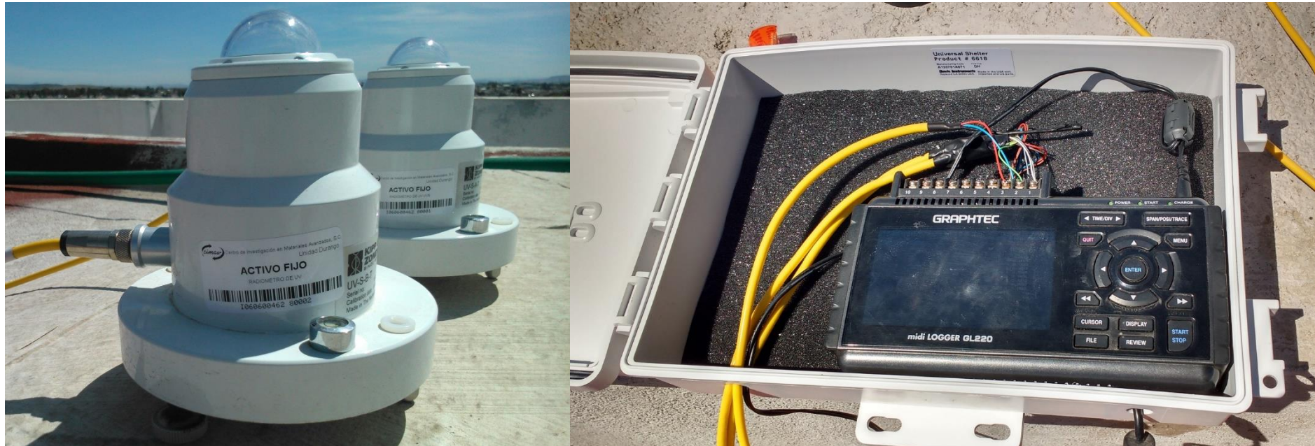
Figura 3. Sistema de muestreo: radiómetros Kipp & Zonen UV-S-A-T y UV-S-B-T (izq.) y adquisidor de datos Graphtec GL220 (der.).
